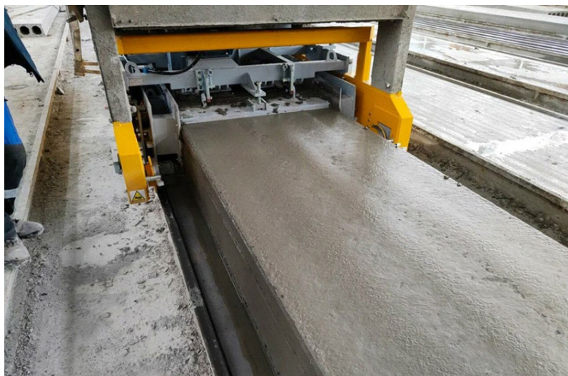
Рис. 4. Линия безопалубочного формования пустотных плит перекрытий
